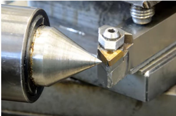
Obr. 57: Ustavení nože do osy obrábění
