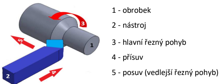
Obr. 33: Řezné pohyby při soustružení
